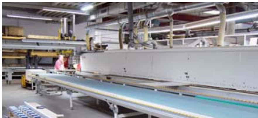
Die Ima-Novimat-Kantenanleimmaschine läuft mit Hot-Air-Injection oder mit PUR
